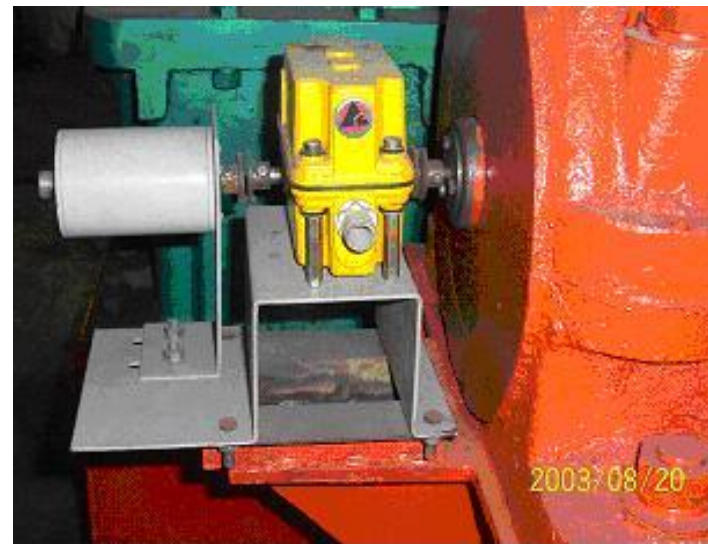
图4-1 编码器和限位开关安装实物图
